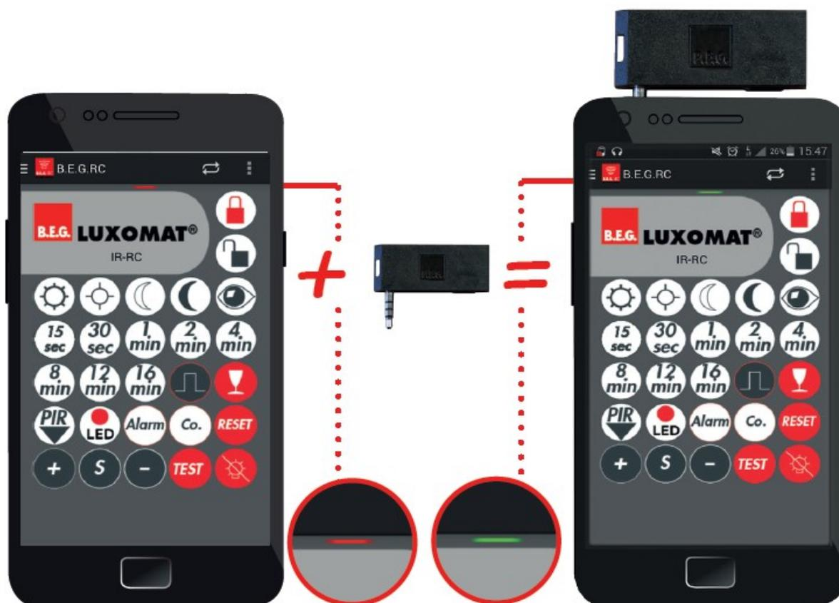
**Etape 4:** Mettez l'adaptateur IR-RC dans la prise jack du casque. Il est possible que les couvercles empêchent une bonne connexion. Notez que l'adaptateur IR RC est entièrement branché dans l'entrée audio.
