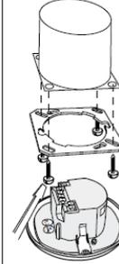
Le détecteur peut être monté au plafond dans des boîtiers simples et conventionnels.
