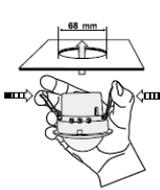
Ce détecteur a été développé spécialement pour l'installation dans des faux plafonds. D'abord, une ouverture ronde de 68 mm de diamètre doit être faite dans le plafond.
