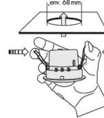
Ce détecteur a été développé spécialement pour l'installation dans des faux plafonds.
