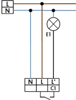
Fonctionnement de base avec interrupteur extérieur de marche forcée
